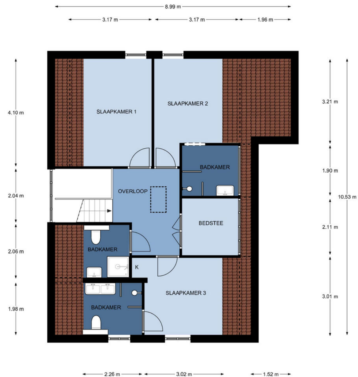
1e Verdieping, Weversblêd 14 te Delfstrahuizen De plattegronden zijn geschikt voor promotionele doeleinden. Er kunnen geen rechten aan ontleend worden. © Topr.nl
